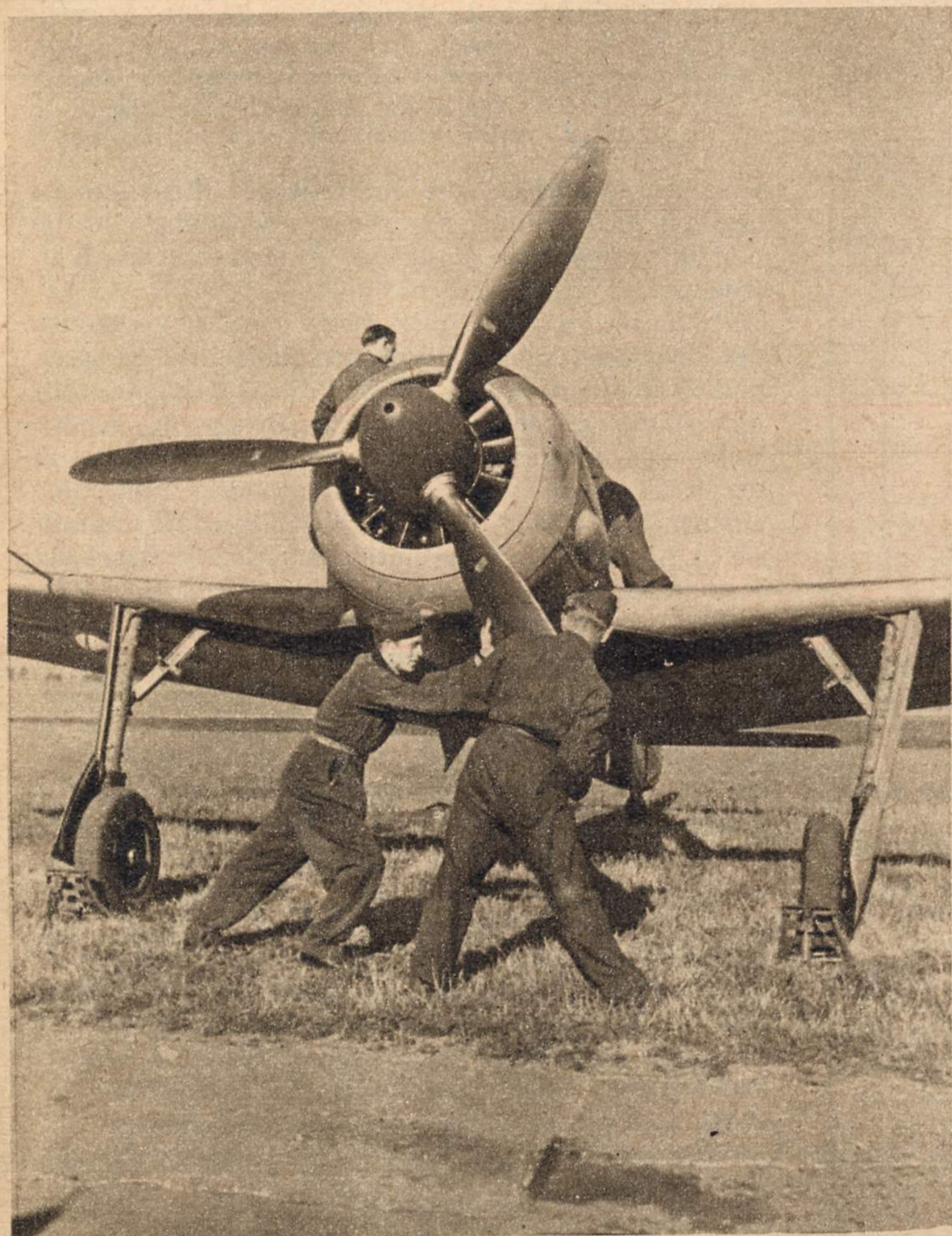
Beim Anwerfen des Motors vor dem Start. Der Jagdeinsitzer Fw 190 ist mit einem 14 Zylinder-BMW-Doppelstern-Motor von höchster Leistungsfähigkeit ausgerüstet
